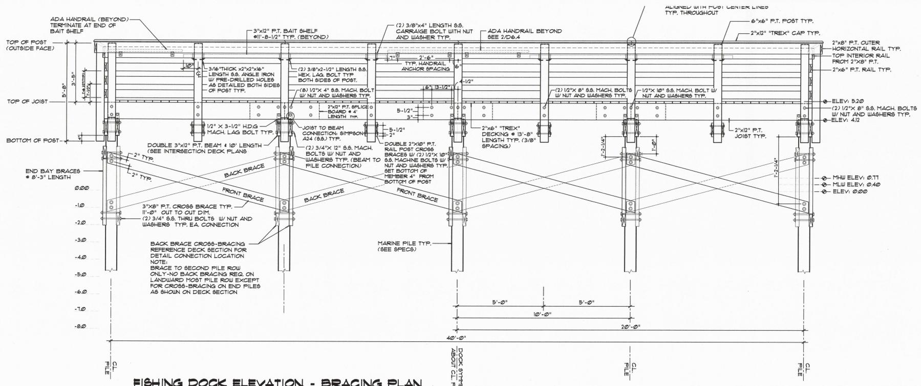
**FISHING DOCK ELEVATION - BRACING PLAN**
